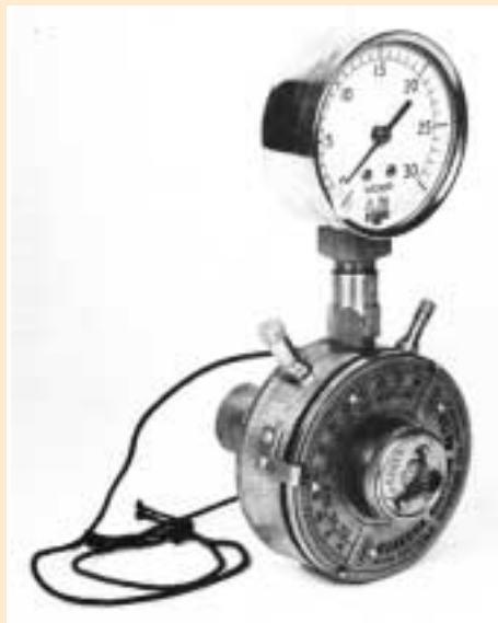
Strumentazione per la misurazione dei flussi di aria negli impianti di mungitura (flussometro e vuotometro)
