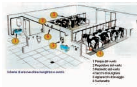
Schema impianto mungitura con vacche alla posta
