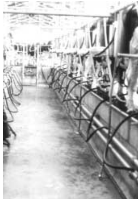
Sala di mungitura tradizionale "linea del latte bassa"
