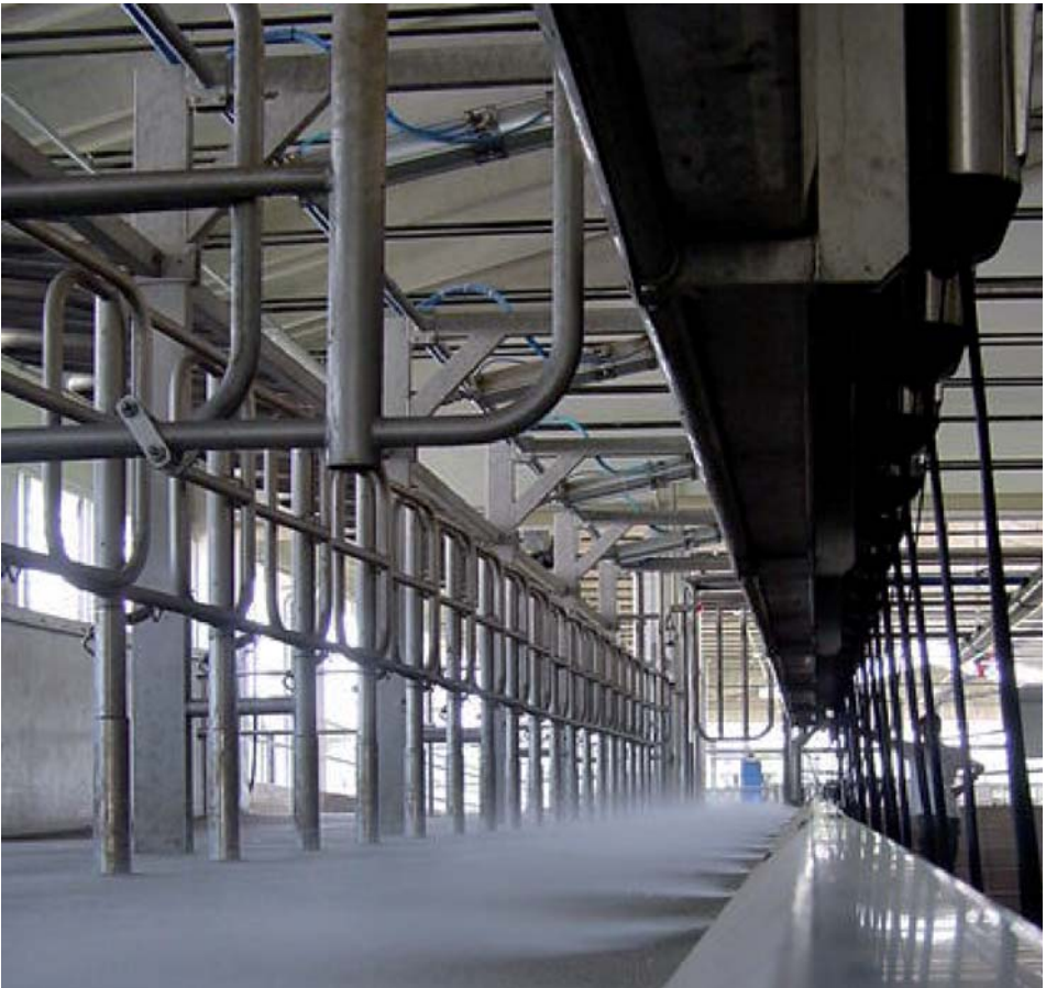
Figura 1 - Visione lavaggio corsie sala di mungitura in automatico
